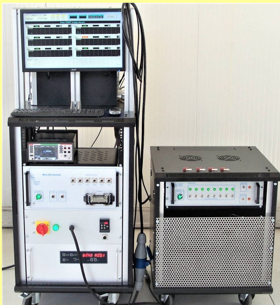
Foto del sistema di prova con simulatore carico resistivo 4 KW
